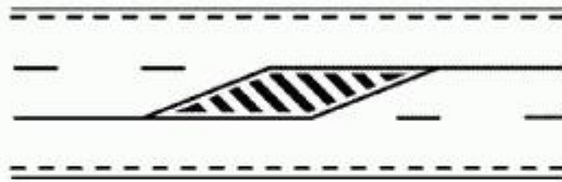
Marcaj pe drum cu trei benzi pentru alocarea alternativă a doua benzi pentru unul sau celălalt sens de circulație
