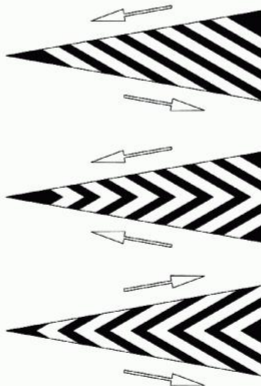
Spații interzise circulației
