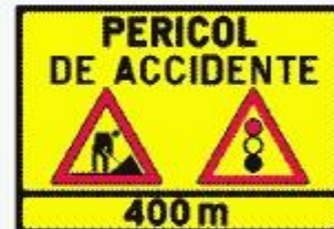
Presemnalizarea unui sector cu circulație alternantă
