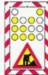
Semnalizarea unui utilaj care se deplasează lucrând
