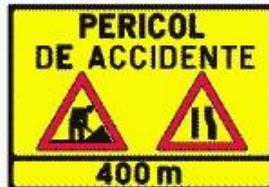
Presemnalizarea unui sector cu circulație alternantă
