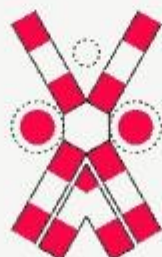
Trecere la nivel cu o cale ferată dublă, fără bariere, prevăzută cu semnale luminoase de avertizare a apropierii trenului
