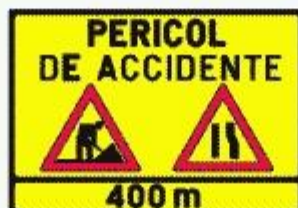
Presemnalizarea unui sector cu circulație alternantă
