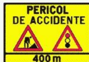
Presemnalizarea unui sector cu circulație alternantă
