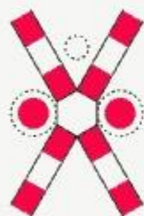
Trecere la nivel cu o cale ferată simplă, fără bariere, prevăzută cu semnale luminoase de avertizare a apropierii trenului
