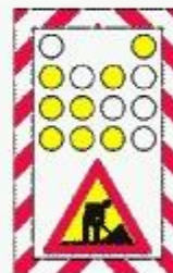
Semnalizarea unui utilaj care se deplasează lucrând
