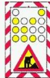
Semnalizarea unui utilaj care se deplasează lucrând
